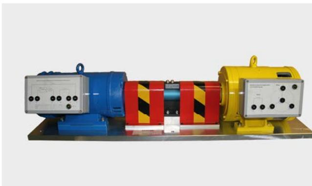
Fremderregter Gleichstrom-Doppelschluss-Motor (6 kW bei 3000 min<sup>-1</sup>) gekuppelt über Drehmomentmesswelle mit fremderregtem Drehstrom-Synchrongenerator geeignet zur Netzeinspeisung in das 400 V/50 Hz Netz. Über den Dämpferkäfig des Synchrongenerators kann die Maschine asynchron hochgefahren werden.
