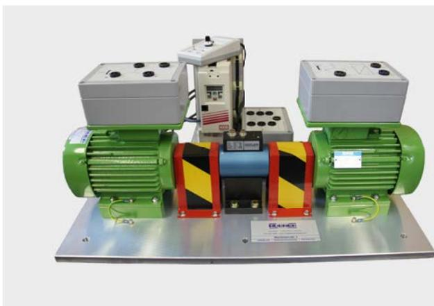
Permanenterregter Drehstrom-Synchronmotor gekuppelt über Drehmomentmesswelle mit permanenterregtem Drehstrom-Synchrongenerator. Der Synchronmotor (3 kW bei 3000 min<sup>-1</sup>) wird sensorlos mit einem Frequenzumrichter betrieben. Die Belastung erfolgt über den Synchrongenerator, eine Leistung von 2,5 kW über einen Stromrichter mit Phasenanschnittsteuerung ins Netz einspeisen kann.
