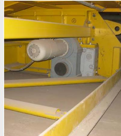
Die Voraussetzung um dieses 100 Tonnen Gießpfannen-Transportfahrzeug über Batteriespeisung für 20 Fahrten pro Schicht einsatzbereit zu halten und mit einer Geschwindigkeit von mindestens 10 m/min zu bewegen, wird von **JOHANNES HÜBNER GIESSEN** mit zwei Gleichstrom-Motoren der Baureihe GN 17 mit eingebauter Federdruckbremse erfüllt. Die Speisung des Motors erfolgt über einen digitalen Regler.
