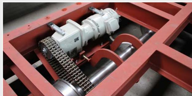
Das abgebildete ferngesteuerte Schienenfahrzeug fördert eine Last von 30 Tonnen mit 17 m/min. Hierfür verbaut **JOHANNES HÜBNER GIESSEN** einen Gleichstrom-Nebenschlussmotor mit Fremderregung und angebaubtem Stirnradgetriebe mit einer Leistung von 3 kW. Gespeist wird der Motor mit 96 V Batteriespannung über einen analogen Regler, der einen großen Geschwindigkeitsbereich zulässt.
